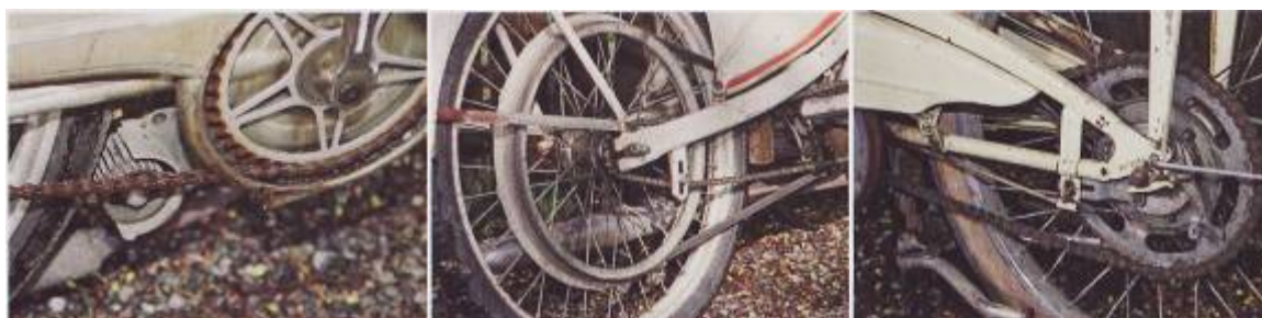
Figur 13. Tre drivfunktioner, från vänster: rulle, rem och kedja. Källa: Flodén, Gunnar, Fylla moppe: Så minns vi mopedens guldålder: 50 cc som förändrade Sverige (Uppsala 2008), 26.
